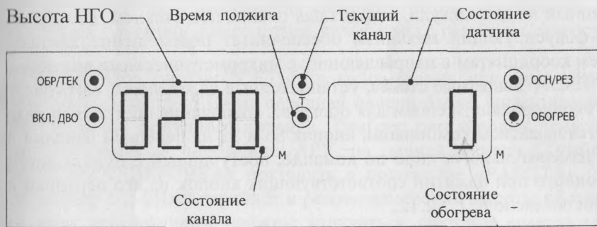
Рисунок 2 Передняя панель пульта дистанционного
