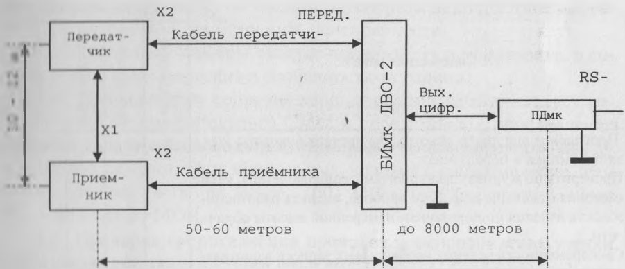
Рисунок 3 Схема монтажная ДВО-2
